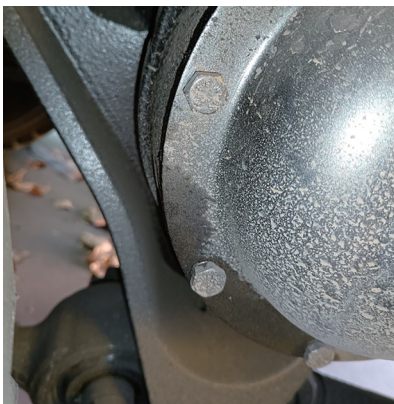
图1 壳盖结合面处漏油
