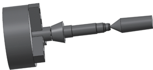
图6 有端面驱动装夹示意
