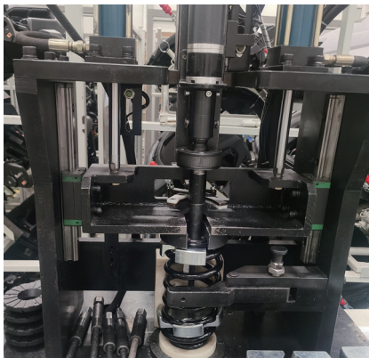
图3 后螺旋弹簧总成压缩过程以及塑形过程
