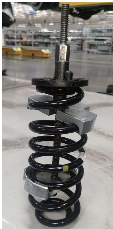
图4 后螺旋弹簧总成压缩塑形状态
