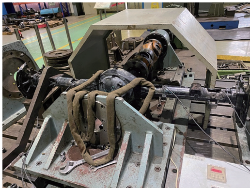
图4 驱动桥半轴测试
