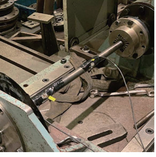
图2 扭转试验台加载转矩采集应变值
