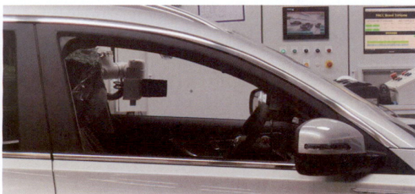
图3 应用协作机器人的车辆HUD检测
