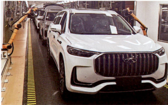
图1 板链上的整车外观检测
