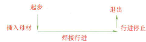
图11 焊接前焊接轨迹
