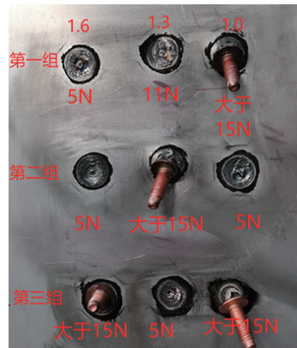
图5 扭矩检验和破检情况
