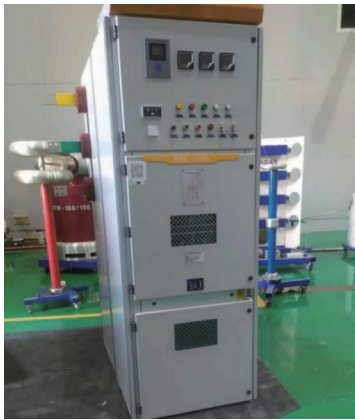
图 8 开关柜温升试验图
