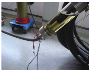
图5 电缆尖端故障缺陷模型图
