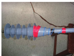
图9 电缆悬浮故障缺陷模型图
