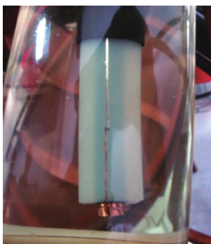
图7 电缆沿面故障缺陷模型图
