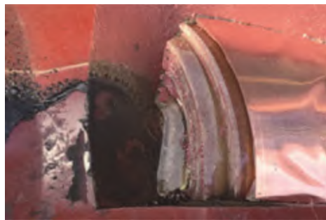
图3 电压互感器匝间绝缘短路
