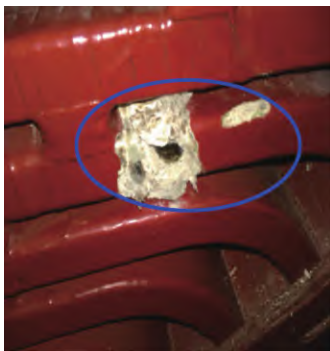
图2 定子线棒绝缘有缺陷导致击穿
