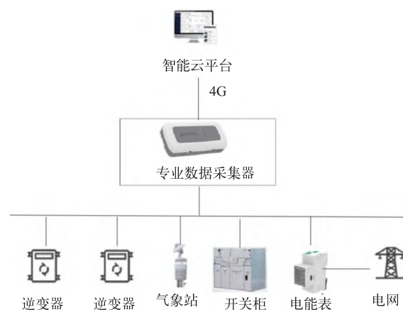
图8 小型工商业电站接入平台方案
