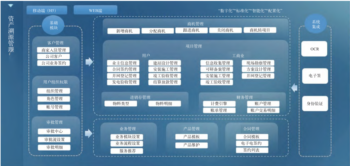
图3 资产溯源模块架构设计图
