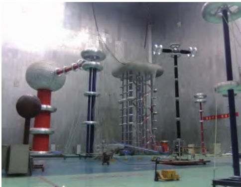
图14 绝缘试验、无线电干扰试验
