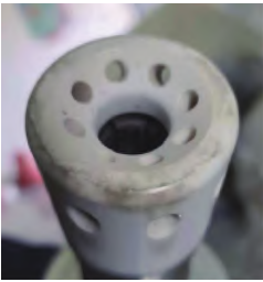
图1 A相大喷口与弧触头烧蚀情况 图2 A相小喷口烧蚀情况
