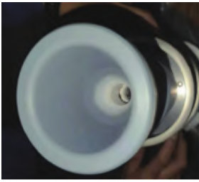
图1 A相大喷口与弧触头烧蚀情况 图2 A相小喷口烧蚀情况
