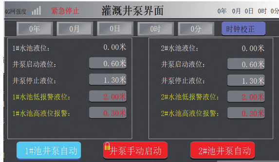
图6 井泵控制界面
