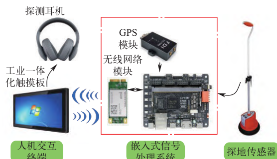
图1 基于声磁特征匹配分析的地下电缆故障定位系统布局示意图
