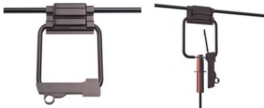
图3 接地引流线夹闭合与打开旁路连接状态
