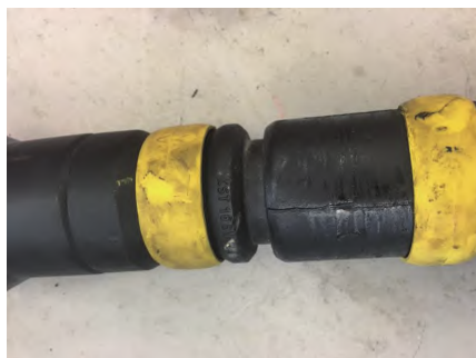
图1 连接器无法正常分离
