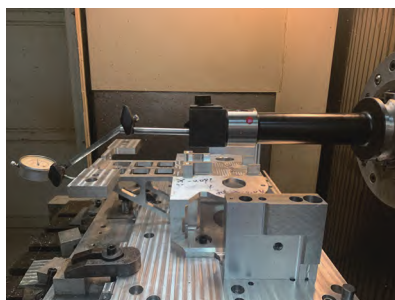
图5 端面精密孔加工辅助工装的实际应用
