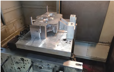
图4 4轴卧式加工中心多工位通用工装的实际应用
