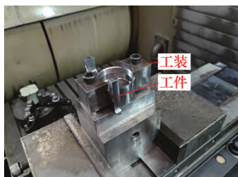
图17 铣削后的双侧支耳外侧台阶
