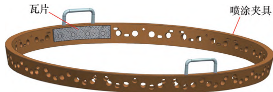
图9 瓦片喷涂装夹示意
