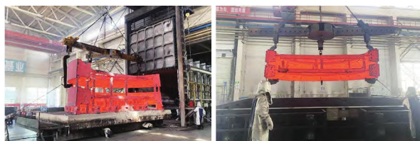
a) 半齿轮装炉加热
