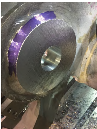
图3 孔的表面加工质量
