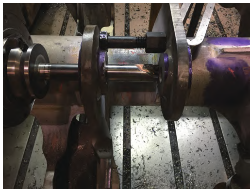
图7 螺旋分层铣削
