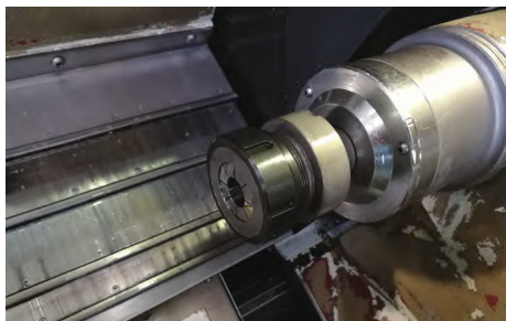
图6 顶针在机床尾座的实际安装情况
