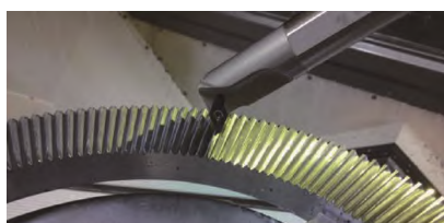
图8 35^\circ 内孔车刀精铣的端面齿成品
