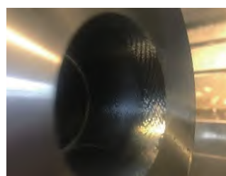
a) 普通钢制镗杆加工效果（有振纹）
