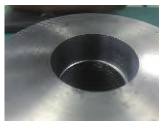
b) 减振镗杆加工效果（无振纹）
