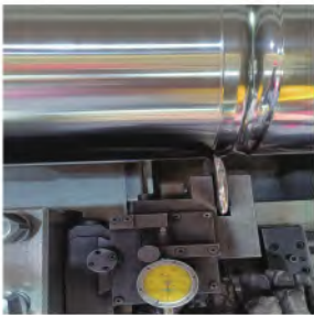
图2 中白车轴现场滚压实物
