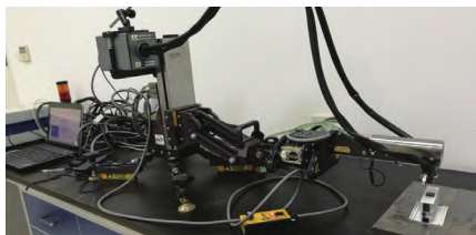
a) 车轴样品残余应力检测设备
