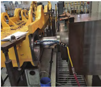
图2 立铣刀螺旋插补铣削端面槽
