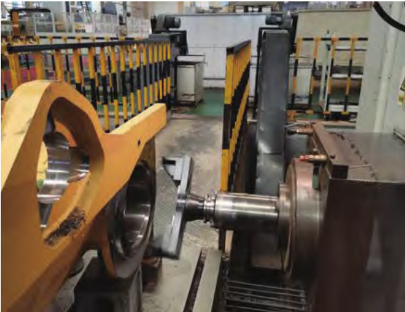
图8 端面槽镗削加工
