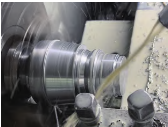
图13 零件右端螺纹退刀槽加工
