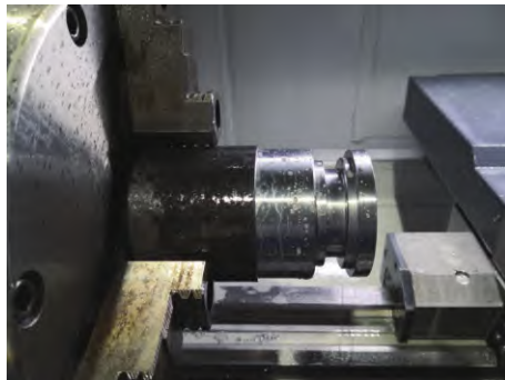
图12 零件左端矩形外沟槽精加工
