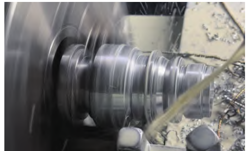
图14 零件右端矩形外沟槽加工
