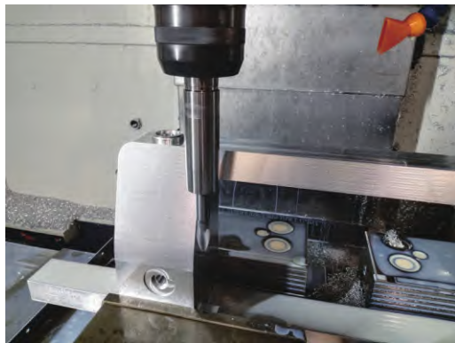
图5 曲面精加工实景
