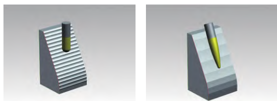
c) 球刀加工轴测图
