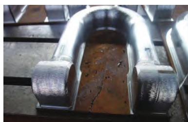
图2 热处理后工件中间开裂
