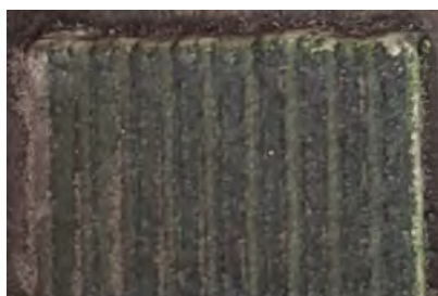
图5 梯度熔覆后的效果
