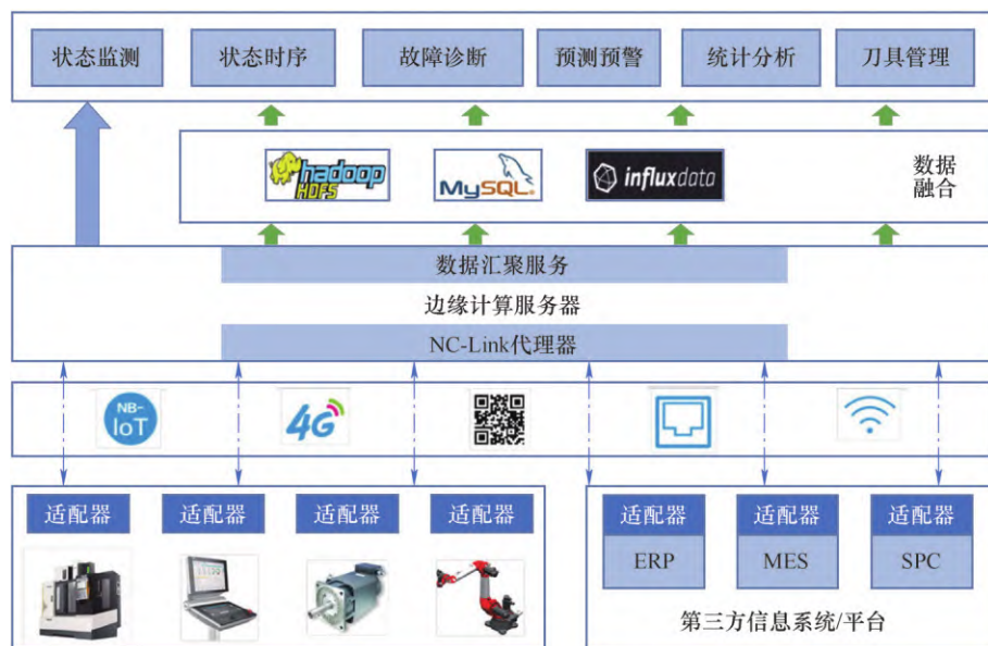
图1 基于NC-Link协议的边缘数据协议栈设计方案
