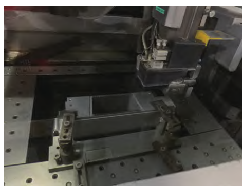
图6 箱体窄缝导轨槽的线切割加工
