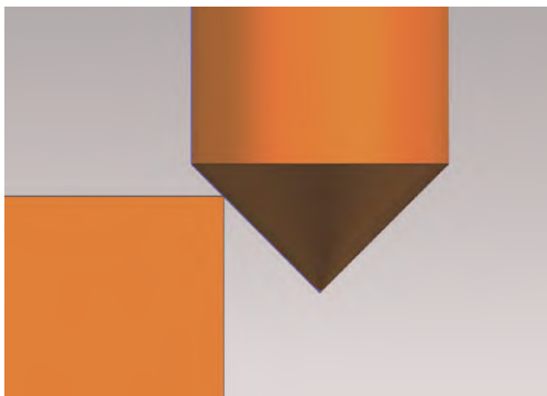
图5 倒角刀与工件相接触
