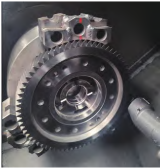
图4 调整后的自定心卡盘夹持方式
