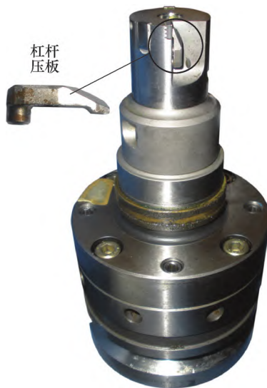
图4 复合专用刀具杠杆压板结构
