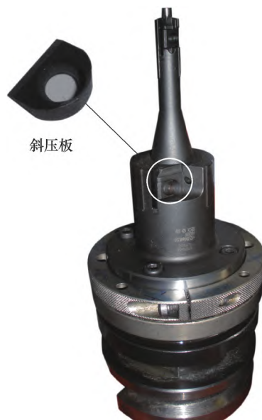
图3 复合专用刀具斜压板结构
