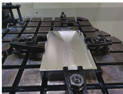
图5 精加工反面圆弧曲面后的工件实物
