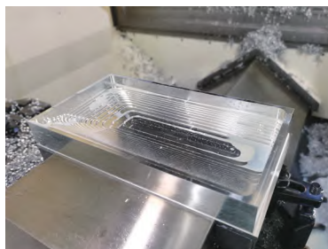
图4 稳流盖粗加工实物
