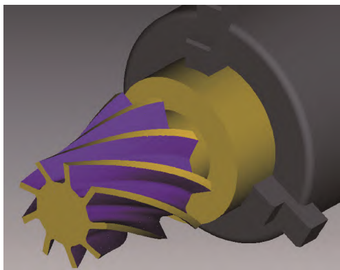
图10 螺旋槽仿真结果
