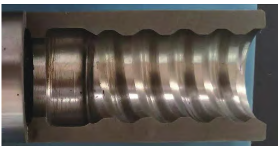
图9 实际切削工件剖面
