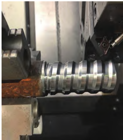
图11 钎杆外螺纹切削结果
