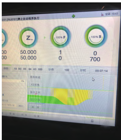
图10 外螺纹加工模拟
