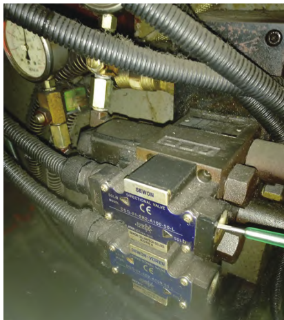
图4 机床铣削模式切换液压控制阀
