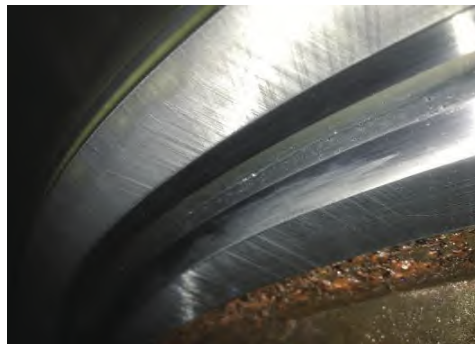
图2 工作台轴承磨损
