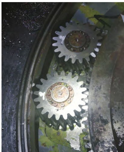
图5 工作台定位齿轮副中斜齿轮
