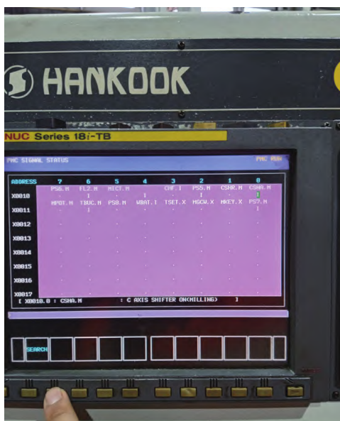
图7 I/O检测界面确定铣削模式信号
