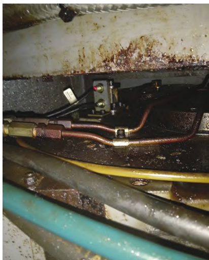
图6 铣削车削切换信号灯
