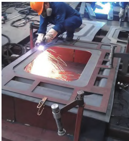
图7 切割内圈示意
