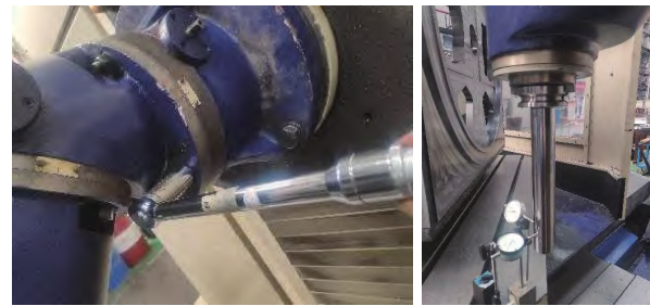
a) 松开紧固螺母 b) 测跳动量
