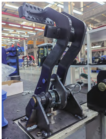
图6 装配工装现场使用状态
