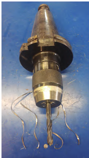
图7 \phi 8\text{mm} 普通钻头
