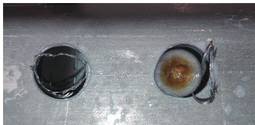
图3 钻尖烧蚀导致切屑圆中心成黄色
