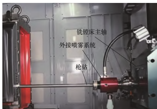
图4 铣镗用深孔钻结构示意图
