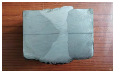
图5 焊缝横截面宏观金相（42mm，X形）
