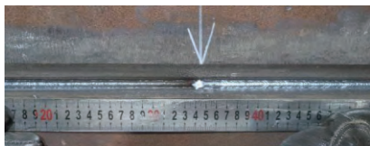
图7 气体保护焊打底+填充第一道焊缝成形 (42mm, X形)
