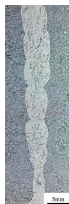
图3 焊接接头的截面宏观形貌
