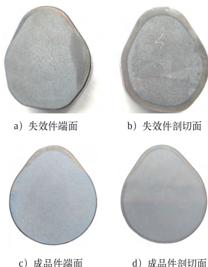
图4 凸轮轴横向解剖端面及剖切面淬火区域宏观形貌
