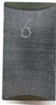
图3 凸轮轴轴向纵剖面淬火区域宏观形貌
