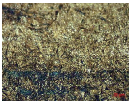
图6 凸轮淬硬层金相组织
