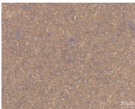
图12 边缘件油淬后金相组织（硬度773HV）
