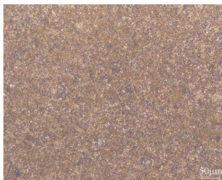
图13 中间件油淬后金相组织（硬度614HV）
