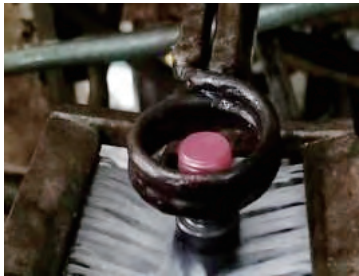
图6 双线圈感应器
